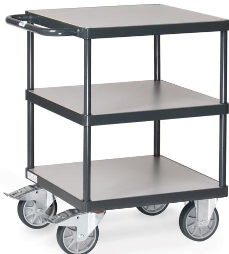
Tischwagen mit dem MultiVario Baukasten-System aus Stahlrohr und Profilstahl geschweißt, pulverbeschichtet anthrazitgrau RAL 7016. Dauerhaft oberflächengeschützt, schlag- und kratzfest. 3 Plattformen aus Holzwerkstoffplatte, Oberfläche mittelgrau. Die Systemteile werden einfach eingesteckt und festgeschraubt. 2 Lenk- und 2 Bockrollen mit TPE-Bereifung und Nabensicherung. Feststeller an den Lenkrollen. Tragkraft obere Ladefläche 200 kg.
