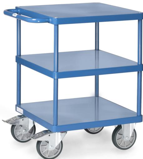
Tischwagen mit dem MultiVario Baukasten-System aus Stahlrohr und Profilstahl geschweißt, pulverbeschichtet brilliantblau RAL 5007. 3 Plattformen aus Stahlblech, bündig im Rahmen, sauber eingeschweißt, ebenfalls pulverbeschichtet RAL 5007. 2 Lenk- und 2 Bockrollen, TPE-Bereifung, Nabensicherung mit Rillenkugellager. Feststeller an den Lenkketten. Tragkraft obere Ladefläche 200 kg.
