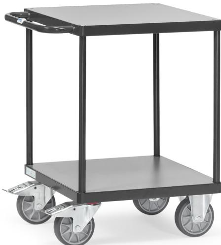
Tischwagen mit dem MultiVario Baukasten-System aus Stahlrohr und Profilstahl geschweißt, pulverbeschichtet anthrazitgrau RAL 7016. Dauerhaft oberflächengeschützt, schlag- und kratzfest. 2 Plattformen aus Holzwerkstoffplatte, Oberfläche mittelgrau. Die Systemteile werden einfach eingesteckt und festgeschraubt. 2 Lenk- und 2 Bockrollen mit TPE-Bereifung und Naben mit Rillenkugellager. Feststeller an den Lenkketten. Tragkraft obere Ladefläche 200 kg.
