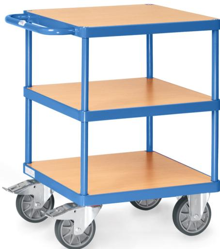
Tischwagen mit dem MultiVario Baukasten-System aus Stahlrohr und Profilstahl geschweißt, pulverbeschichtet blau RAL 5007. Dauerhaft oberflächengeschützt, schlag- und kratzfest. 3 Plattformen aus Holzwerkstoffplatte, Oberfläche Buchendekor. Die Systemteile werden einfach eingesteckt und festgeschraubt. 2 Lenk- und 2 Bockrollen mit TPE-Bereifung und Nabensicherung. Feststeller an den Lenkrollen. Tragkraft obere und mittlere Ladefläche 200 kg.
