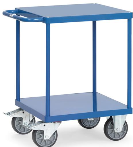
Stahlrohr und Profilstahl geschweißt, pulverbeschichtet brillantblau RAL 5007. 2 Plattformen aus Stahlblech, bündig im Rahmen, sauber eingeschweißt, ebenfalls pulverbeschichtet RAL 5007. 2 Lenk- und 2 Bockrollen, TPE-Bereifung, Naben mit Rillenkugellager. Feststeller an den Lenkrollen. Tragkraft obere Ladefläche 200 kg.
