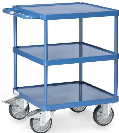
Tischwagen mit dem MultiVario Baukasten-System aus Stahlrohr und Profilstahl geschweißt, pulverbeschichtet brilliantblau RAL 5007. 3 Stahlblechwannen mit 10 mm hohem Rand, öldicht verschweißt, pulverbeschichtet RAL 5007. 2 Lenk- und 2 Bockrollen, TPE-Bereifung, Nabens mit Rillenkugellager. Feststeller an den Lenkrollen. Tragkraft obere Ladefläche 200 kg.
