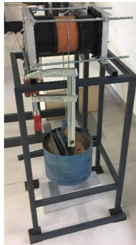
**Abbildung 5:** Prüfaufbau KD 101 4.3.2 Gasdichtigkeit unter radialer Last - Verbindungsrohr und Rahmensystem [1]
