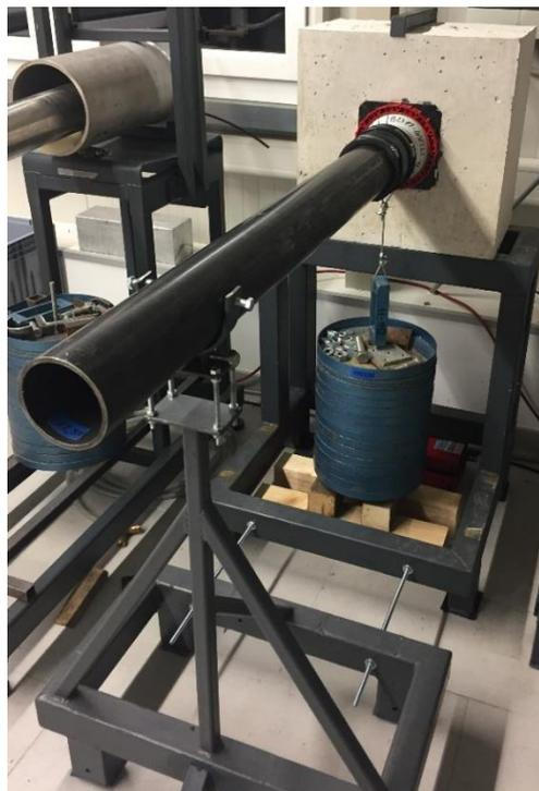
**Abbildung 25:** Prüfaufbau Entwurf KD 101 5.2.2 Dichtigkeit der Systemdeckel für Kabelschutzrohre zur Kabeldurchführung unter radialer Last [3]
