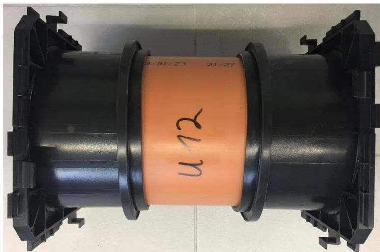
**Abbildung 15:** Prüfmuster KD 101 4.3.4 nach der Belastung
