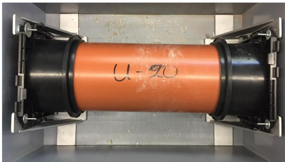
**Abbildung 11:** Prüfmuster KD 101 5.1.3 nach der Schlagbelastung
