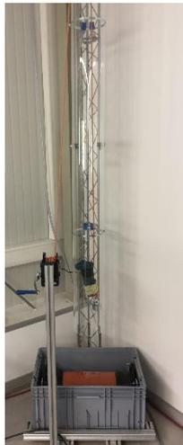
**Abbildung 8:** Prüfaufbau Entwurf KD 101 5.1.3 Schlag- und Stoßbelastung - Verbindungsrohr und Rahmensystem [2]
