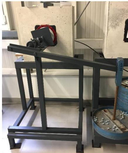
**Abbildung 29:** Prüfaufbau KD 101 4.4.3 Gasdichtigkeit der Systemdeckel für Kabel unter Torsionskräften [1]
