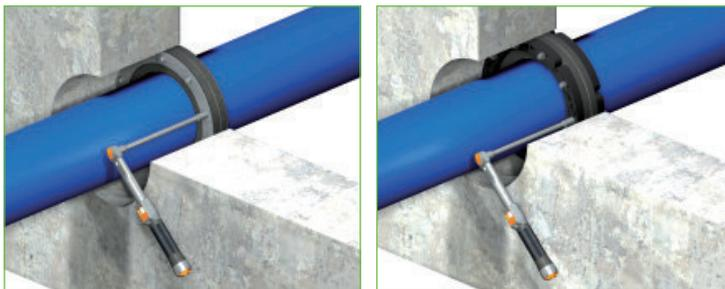
6. Ringraumdichtung wandbündig mit der Außenseite des Gebäudes in das Futterrohr bzw. die Kernbohrung einfügen.
